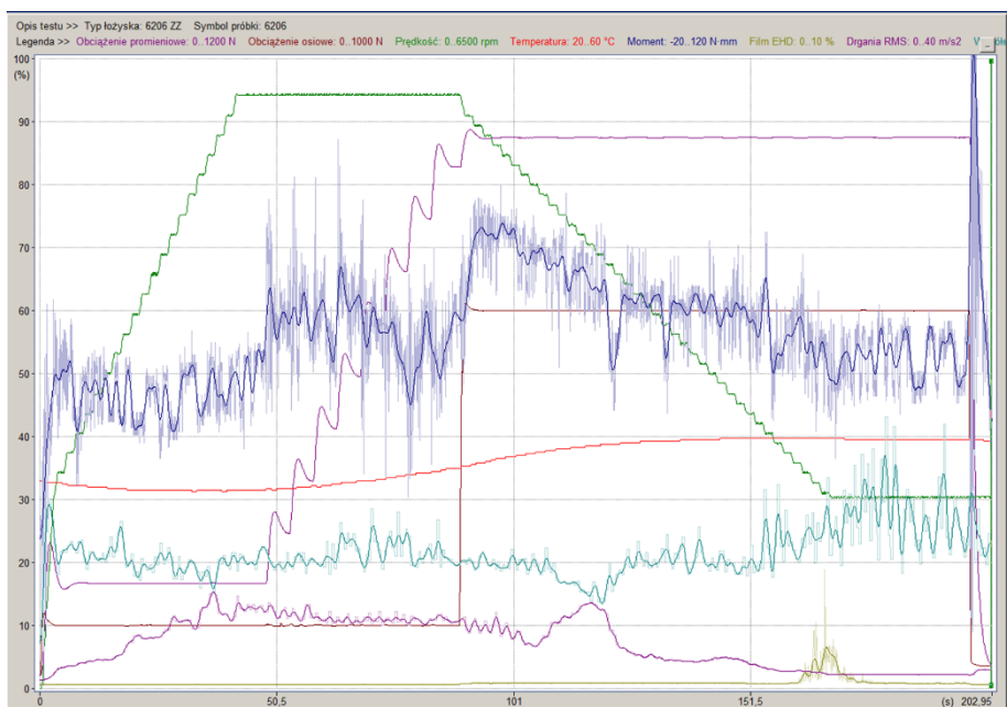
Rys. 4. Przykładowe wyniki uzyskiwane na stanowisku do badań trwałości łożysk tocznych
