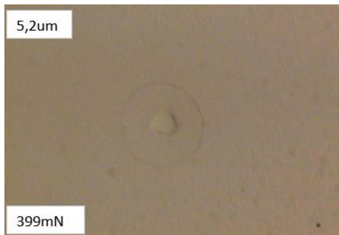
Rys. 8. Obrazy deformacji układu powłoka- podłoże na granicy pola kontaktu wykonane z użyciem Micro Combi Testera dla wgłębniaka o promieniu zaokrąglenia R = 20\ \mu\text{m} a) układ z powłoką 1\ \mu\text{m} , b) układ z powłoką 5,2\ \mu\text{m}
