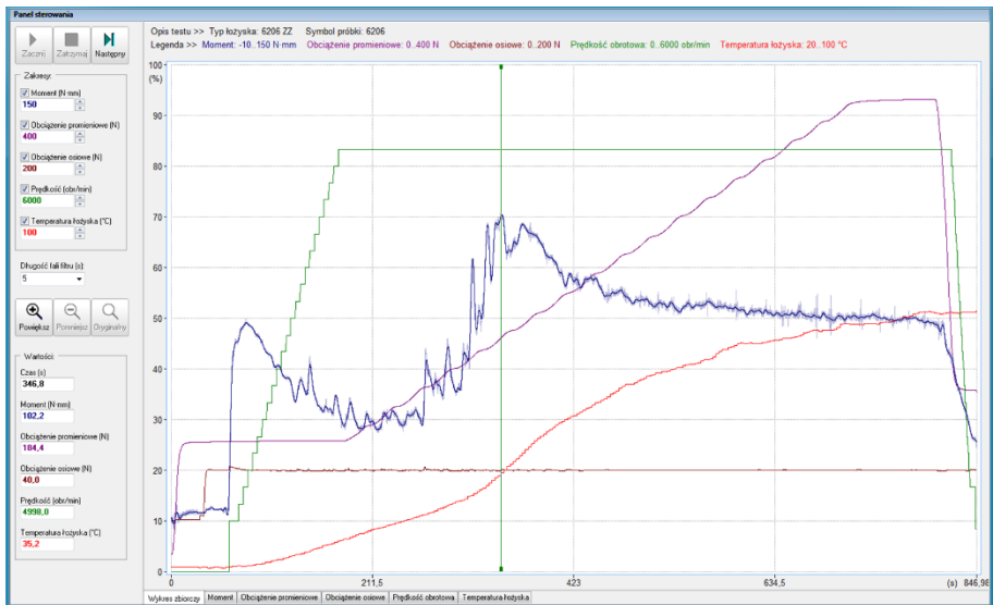
Rys. 8. Przykładowy wynik uzyskany na stanowisku do badań momentu oporowego łożysk tocznych (moment oporowy linia niebieska)
