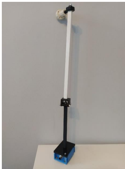
Rys. 8. Wahadło drugiego stopnia z przykręconym czujnikiem TMM88-PCI090 [10]
