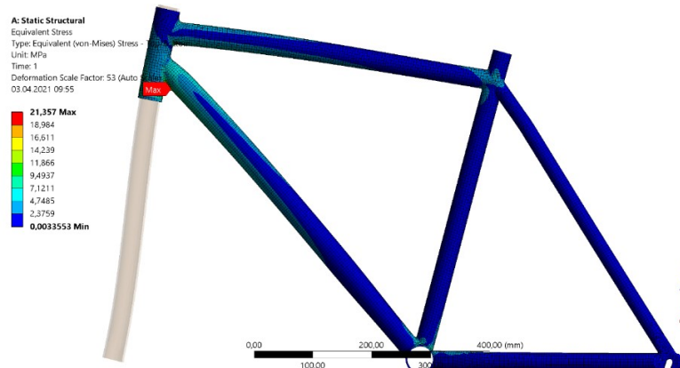
Rys. 5. Naprężenia zredukowane Hubera-Misesa w analizie zmęczeniowej dla analizy z siłami poziomymi
