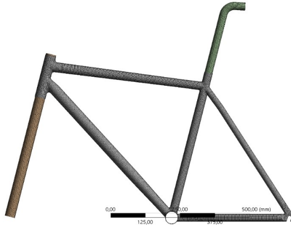
Rys. 4. Siatka elementów skończonych
