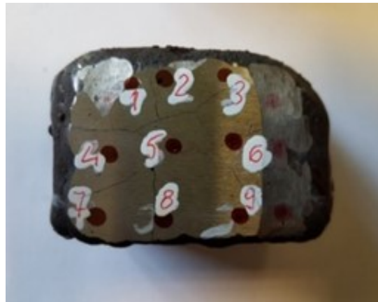
Rys. 7. Odcięty fragment zęba napawanego do pomiaru twardości
