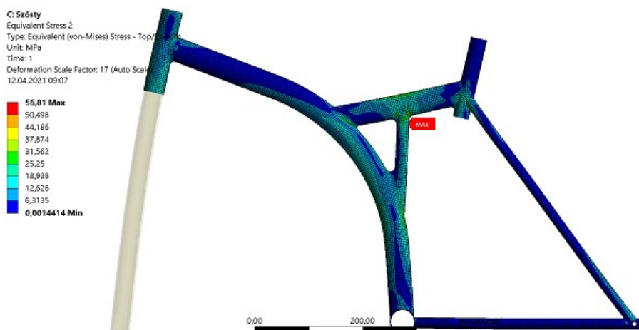
Rys. 16. Mapa naprężeń zredukowanych Hubera-Misesa dla wariantu 6 w analizie zmęczeniowej z siłami poziomymi
