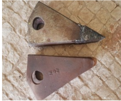
Rys. 6. Zęb zrywaka z napoiną i bez napoiny
