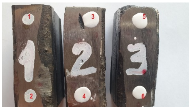
Rys. 14. Punkty pomiaru twardości w wyciętych próbkach
