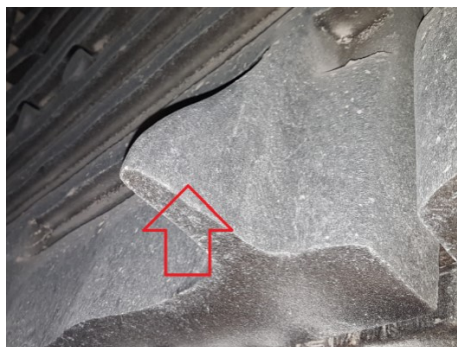
Rys. 11. Zużyta płyta pancerna kruszarki Makrum 40.80 z noskiem
