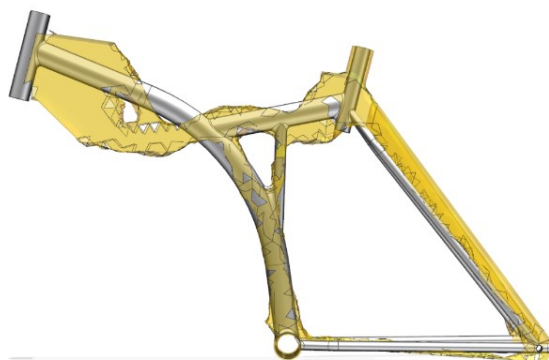
Rys. 9. Model ramy rowerowej z nałożoną geometrią wynikową z optymalizacji topologicznej
