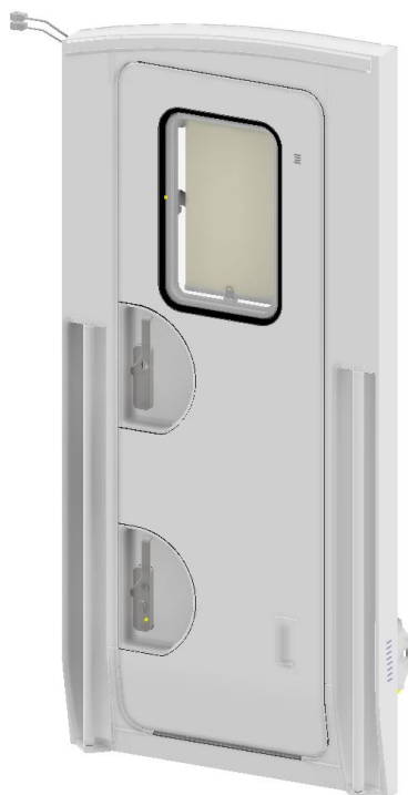
Rys. 1. Drzwi kabiny maszynisty.
