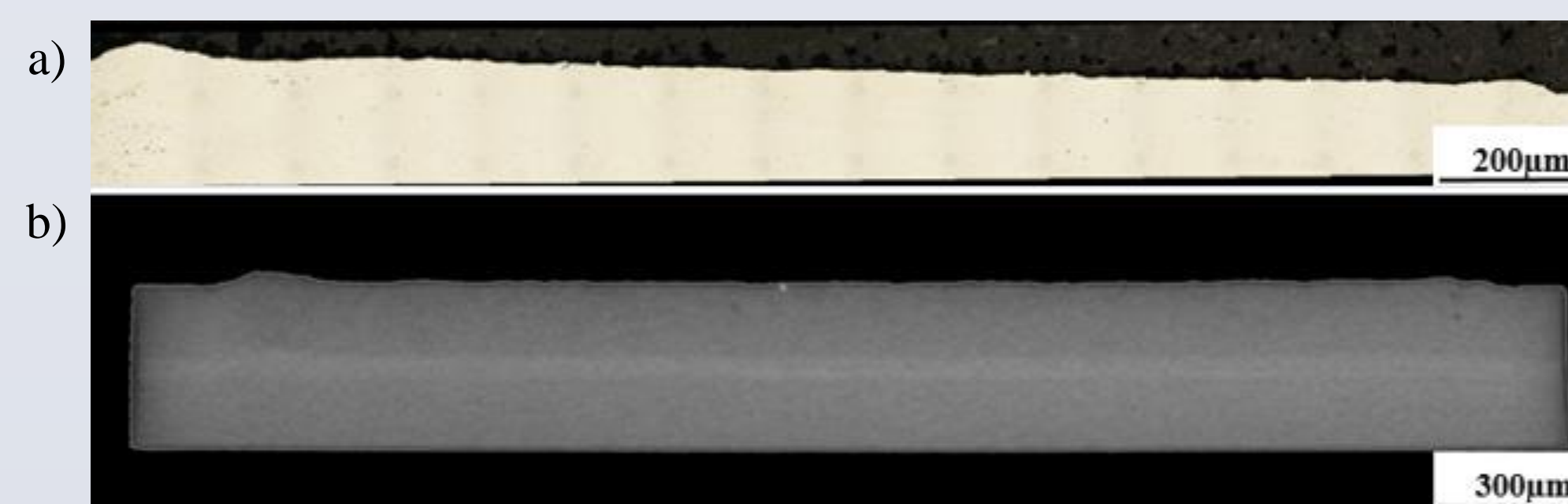
Rys. 4 Makroskopowe widoki napoiny z optymalizacją warunków nanoszenia (podgrzewane podłoże, trzy przejścia na grubości (a); przekrój wzdłużny finalnej napoiny wykonany techniką tomograficzną (b))
