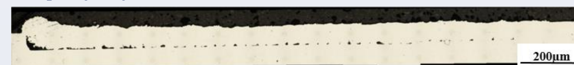
Rys. 3 Makroskopowe widoki napoiny bez optymalizacji warunków nanoszenia
