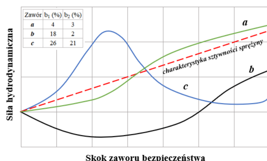
Rysunek 2. Położenie różnych charakterystyk hydrodynamicznych zaworu na tle charakterystyki sztywności sprężyny
